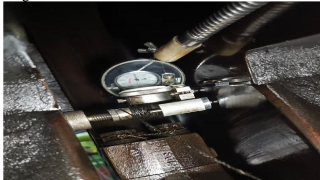
Gambar 7. Proses Crankshaft Deflection Sumber : (Dokumentasi Penulis)
