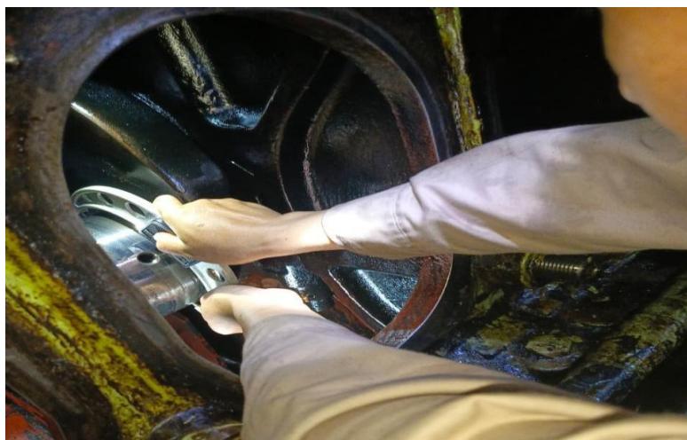
Gambar 8. Proses Pengukuran Craknpin Sumber : (Dokumentasi Penulis)
