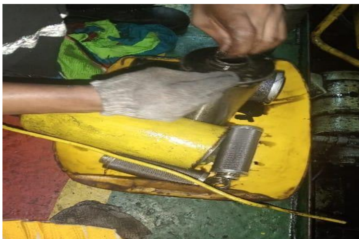
Gambar 10. Pembongkaran Filter oli Sumber : (Dokumentasi Penulis)
