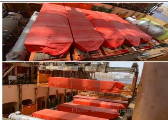
Gambar 1. Posisi OOG di under deck kapal Sumber: Dokumentasi peneliti (2023)
