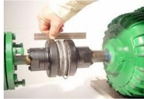
Gambar 4. Metode Alignment Dengan Penggaris
