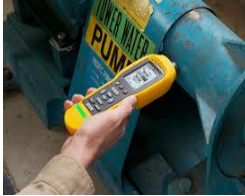
Gambar 3. Pengukuran vibrasi dengan vibration meter
