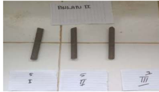
Gambar 17 Besi Karbon Rendah & Besi Karbon Sedang (Lab. Kimia Politeknik Bumi Akpelni)
