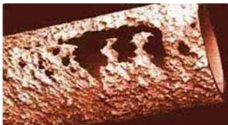
Gambar 4 Contoh korosi merata (Femiana Gapsari, Pengantar Korosi )
